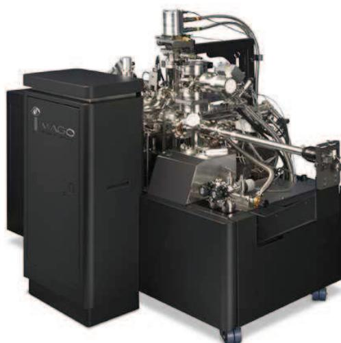
**Figura 8.21.** El sistema LEAP 3.000X Si™ Metrology de Imago SI.
