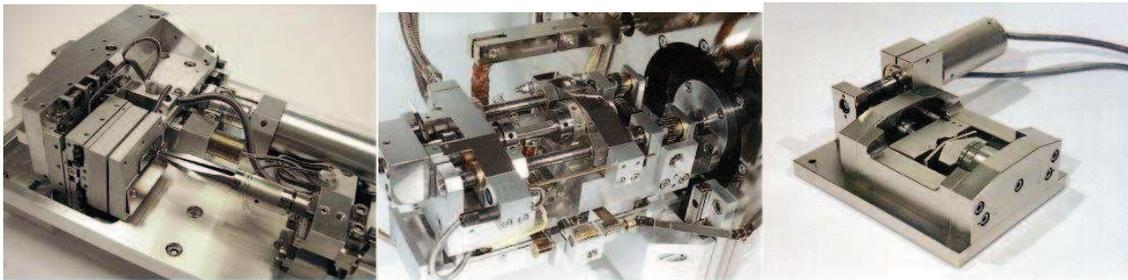
**Figura 8.3.** (Izquierda) Módulo experimental de microensayos de tensión. (Centro) Banco de ensayos de tensión/compresión y (Derecha) Módulo para ensayos de deformación.
