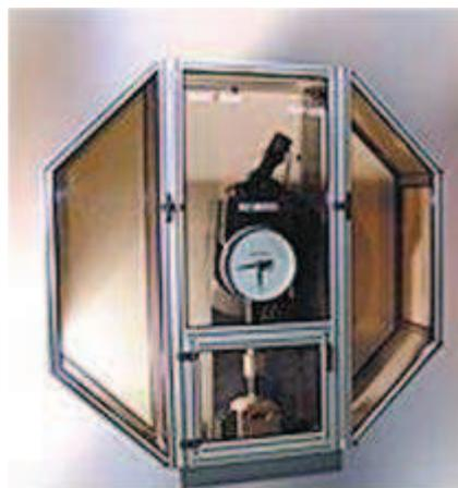
**Figura 8.1.** Péndulo de impacto instrumentado Zwick RKP 450, preparado para ensayos Charpy e Izod.
