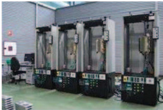
Figura 8.2. Imagen de varias máquinas de fluencia dispuestas en paralelo.
