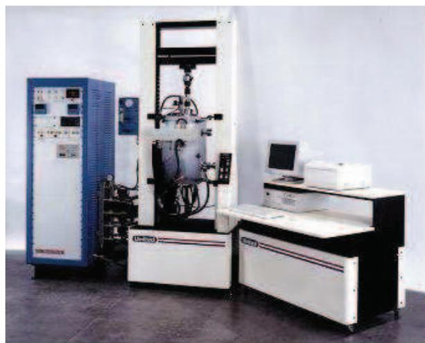
**Figura 8.5.** Horno de atmósfera controlada y alta temperatura dispuesto en un banco de ensayos mecánicos.
