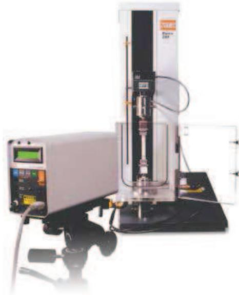
**Figura 8.31.** Sistemas de extensometría láser.
