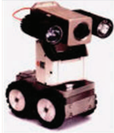
Figura 9.38. Cámara y robot ROVVER 4 para la inspección y mantenimiento en PVNGS (Estación de generación nuclear Palo Verde Nuclear, una planta de fisión nuclear)
