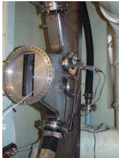
Figura 7.15. Puerto de ensayo de superficie libre del proyecto ISTC 2036 para ensayos con agua 57 .
