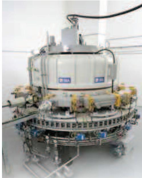
**Figura 5.8.** Acelerador de electrones del tipo Rhodotron (IBA) de 10 MeV de energía máxima.
